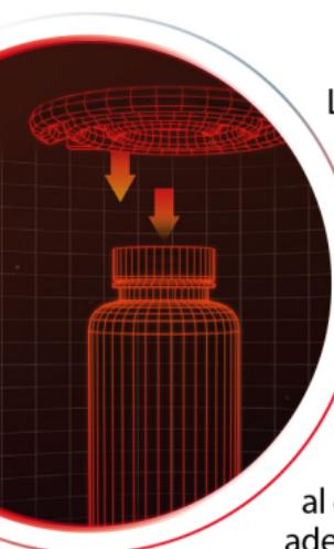
La sigillatura a induzione con tappo o termosaldatura è un processo molto semplice e lineare. Il contenitore è riempito e viene applicato il tappo (dotato internamente di un sigillo in alluminio).
